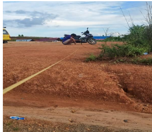
Gambar 13. Pengukuran Akurasi Jarak Pada GPS di Tanah Lapang
