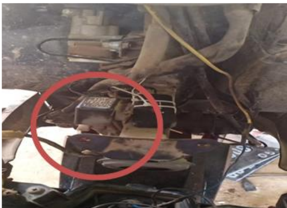
Gambar 2. Posisi alat GPS pada sepeda motor
