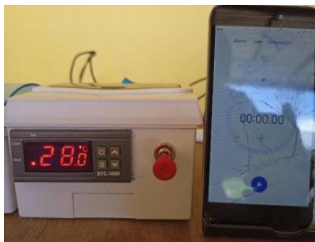
Gambar 2. Pengujian Oven dimulai dari 28°C Angka awal Suhu Temperatur Berikut hasil pengujian kenaikan temperatur Oven yang dapat dilihat pada tabel 2 berikut ini:
