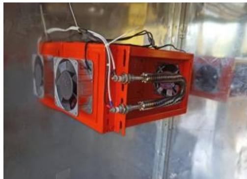
Gambar 13 . Tampak module heater jenis tubular dengan 2 buah kipas
