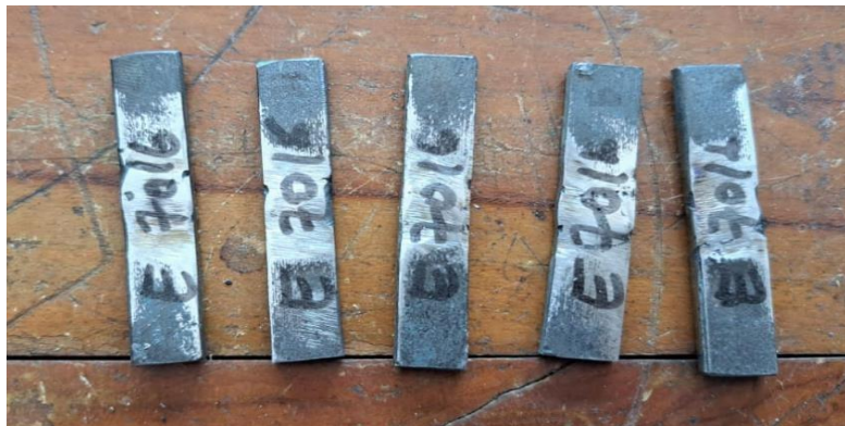
Gambar 9. Hasil Pembuatan Uji Impact E6013
