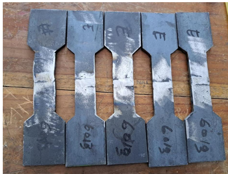
Gambar 10. Hasil Pembuatan Spesimen Uji tarik E6013
