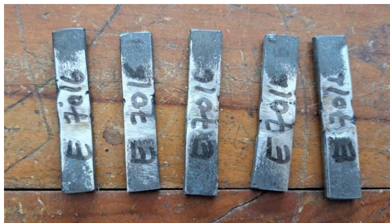
Gambar 8. Hasil Pembuatan Uji Impact E7016
