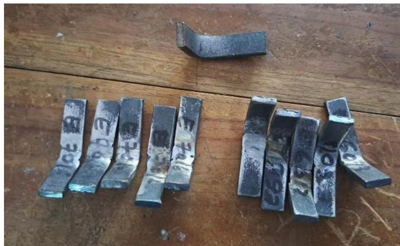
Gambar 16. Hasil Pengujian Impact
