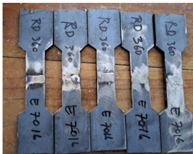
Gambar 11. Hasil Pembuatan Spesimen Uji tarik E7016
