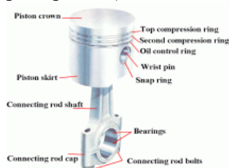
Gambar 1. Piston dan kelengkapannya (Hariyadi and Maftukhin 2016)
